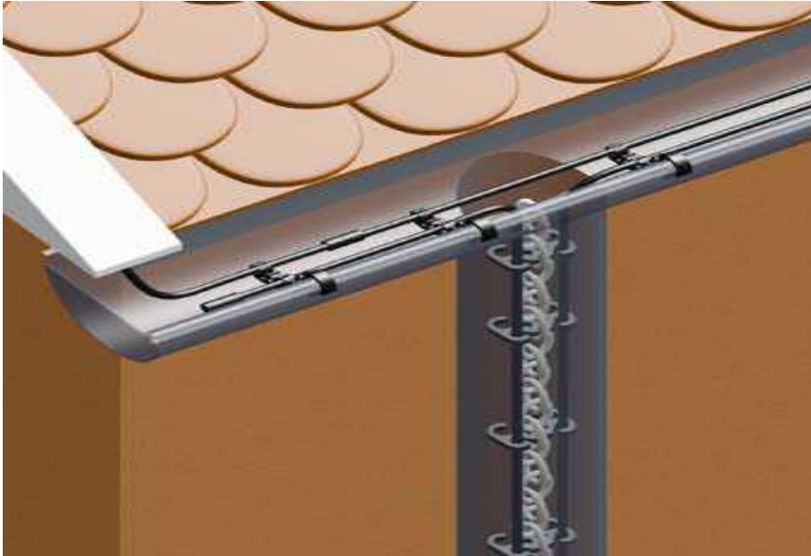
Montaż kabla grzejnego w rynnie
