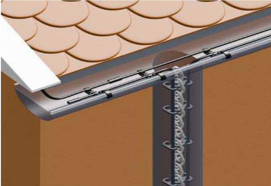
Montaż kabla grzejnego w rynnie
